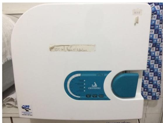
FIGURA 1 – Autoclave Cristófoli VITALE 21 litros utilizada.
